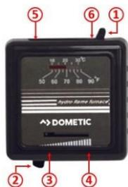
要启动暖气，请将主开关①置于 ON 位置⑤。然后将温度控制②设置为最高级别④以启动。燃烧器将会在 30 秒内点燃。风扇开始吹暖风后，将温度控制②调节到所需水平。主开关①可能很紧，需要多用点力才能打开或关闭。要关闭炉子，请将温度控制设置为最低③级别，然后将主开关置于关闭位置⑥（向右直至其卡入到位）。关闭暖气后，风扇会保持开启状态约一分钟。
