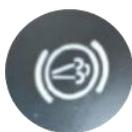
柴油发动机制动器可与拖曳/牵引功能一起使用。启动后，发动机的制动辅助得到增强，提供增强的操控性和控制性，并减少下坡时的制动和变速箱磨损。按下仪表板上的按钮可打开或关闭功能。
