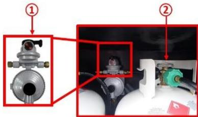
炉头、烤箱、热水器、炉子和冰箱由丙烷操作。为确保有足够的丙烷可用，露营车配备了两个丙烷罐，位于露营车的一个外部隔间中。用于丙烷供应的主阀①直接位于储罐上。黑色小杆②必须指向已打开的丙烷罐。否则，气流会受阻。
